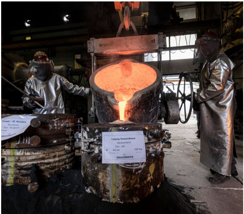
Glocke c2 (Zarathustra) wird gegossen
